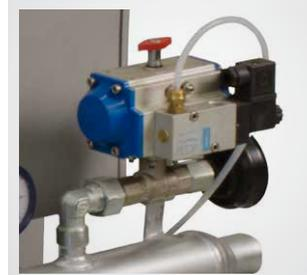
A válvula solenóide de saída garante a passagem de ar comprimido para atmosfera na partida do Booster
