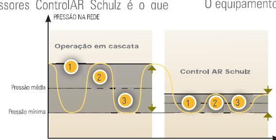
O equipamento permite o comando de até **32 compressores simultaneamente**, limitando as operações em alívio que desperdiçam energia e respeitando às necessidades específicas de cada cliente. O ControlAR Schulz possibilita economia de energia **acima de 35%** dependendo da instalação.
