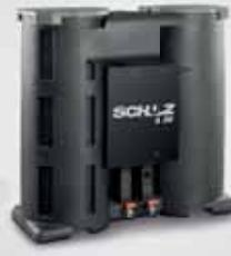
Os separadores de água/óleo da Linha SL removem o óleo (mineral e/ou sintético) do condensado gerado pelos sistemas de ar comprimido. A medida que o condensado flui pelo SL, o óleo é removido da água por diferentes elementos filtrantes.
