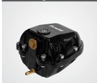
O dreno magnético Schulz possui funcionamento automático, sem a necessidade de utilizar a energia elétrica e sua capacidade de drenagem é de 200l/h. Projetado com carcaça em alumínio e alta resistência a corrosão, consegue operar em temperaturas de até 50°C.
