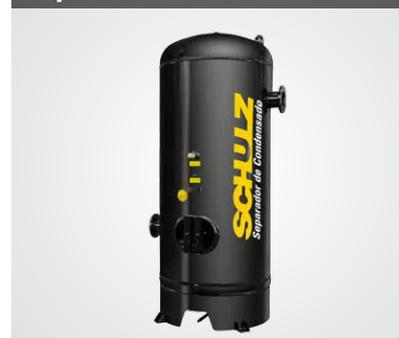
Os Separadores de Condensado SCS Schulz contribuem para a eficiência do tratamento e da rede de ar. Atua como amortecedor de pulsações, favorece a separação da água e do ar, estabiliza a pressão, regulariza o ciclo de carga e alívio e supri demandas volumétricas repentinas ou picos de consumo.
