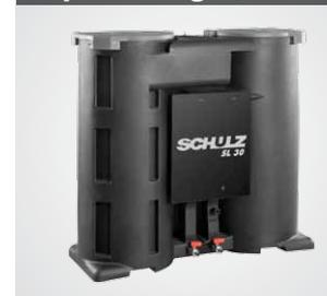
Os separadores de água/óleo da Linha SL removem o óleo (mineral e/ou sintético) do condensado gerado pelos sistemas de ar comprimido. À medida que o condensado flui pelo SL, o óleo é removido da água por diferentes elementos filtrantes.
